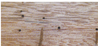
„Pinholes“ bei überseeischen Harthölzern
